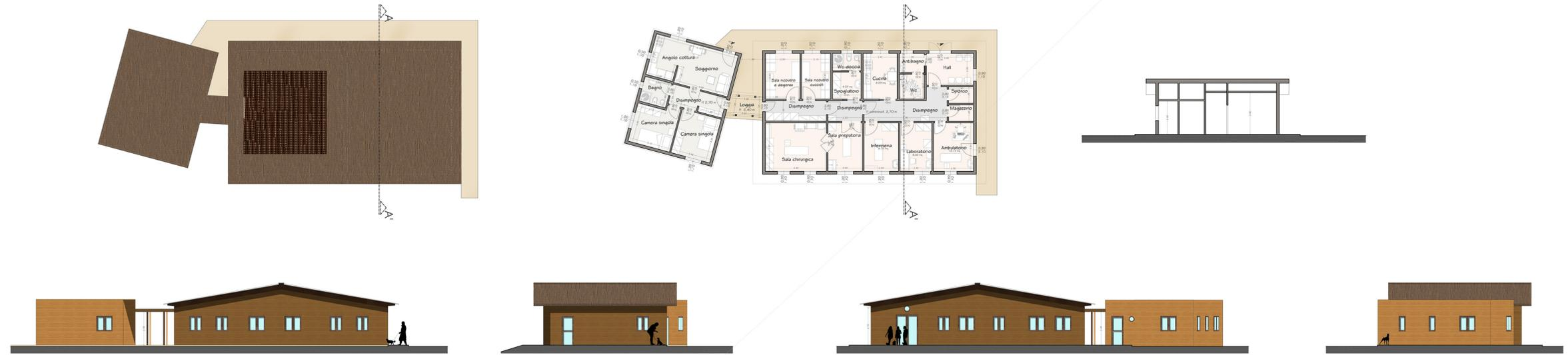
B. PIANTE, SEZIONI E PROSPETTI CANILE RIFUGIO con 10 BOX, AMBULATORIO, SPOGLIATOIO, MAGAZZINO e LOCALE TECNICO Scale 1:100
