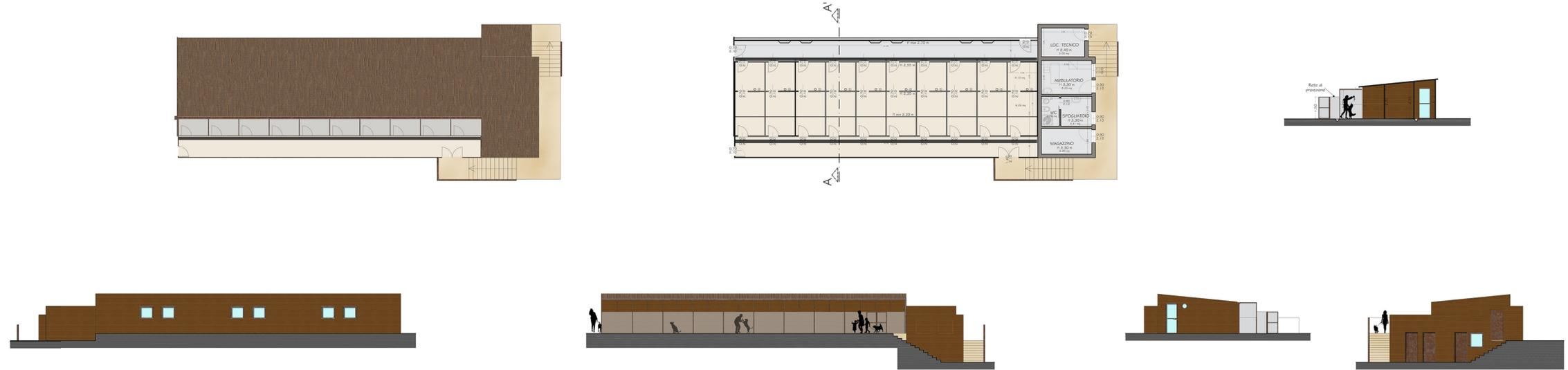
C. PIANTE, SEZIONI E PROSPETTI CANILE SANITARIO con 5 BOX Scale 1:100
